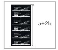
Замеряем ширину помещения. Отрезаем материал с учетом завода материала на стены на 10-20 мм выше планируемого уровня стяжки (b=толщина стяжки + 10/20 мм).
